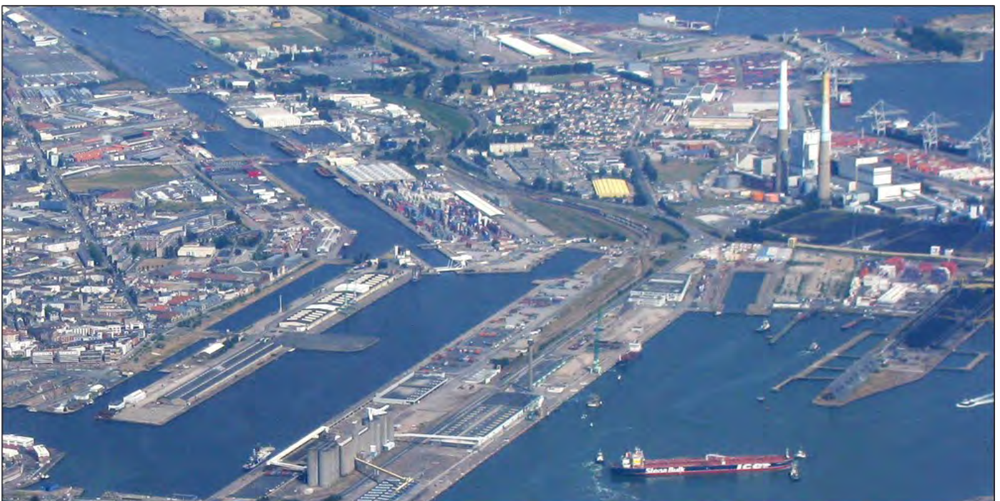
Centrale à charbon de Le Havre en baie de Seine et une partie de son port pétrolier avec à droite de la photographie, la centrale thermique EDF. La tranche de 600 MW à charbon se situe au niveau de la cheminée de 240 m de hauteur (peinture blanche plus nette) et du bâtiment plus haut abritant la chaudière. Devant, ce sont les deux tranches de 250 MW, hors service. On aperçoit le parc à charbon devant l'installation. Photo. J-MT 2014 - Altitude d'origine 1200 m.
